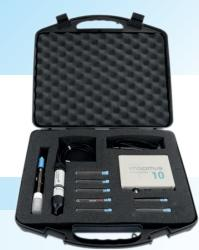
Cette nouvelle sonde portable Imacimus vous permet une mesure en 60 sec de la concentration dans les eaux des 10 paramètres suivants en temps réel : 7 ions/ Ph/ Conductivité/ Dureté de l'eau) : -pH, Cl<sup>-</sup>, NO<sub>3</sub><sup>-</sup>, NH<sub>4</sub><sup>+</sup>, Ca<sub>2+</sub>, Mg<sub>2+</sub>, K<sup>+</sup>, Na<sup>+</sup>, dureté et conductivité.
