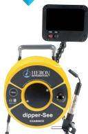
La caméra d'inspection dipper-See EXAMINER est dédiée à la mesure et à la visualisation directe avec enregistrement dans les fonds de puits, puits de forages, canalisations, plans d'eaux ouverts, puits d'égouts, et les tubes étroits de piézomètres à partir d'un diamètre de 1 pouce (25 mm).
